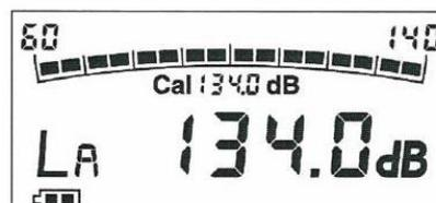
Le niveau de calibrage est situé 6 dB au dessous de la limite haute de la gamme de mesure.
