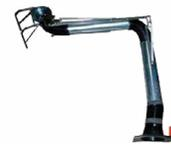
**Bras aspirant** : Recommandé pour des soudures par point fixe ou sur positionneur. L'efficacité décroît rapidement au-delà de 20 cm.
